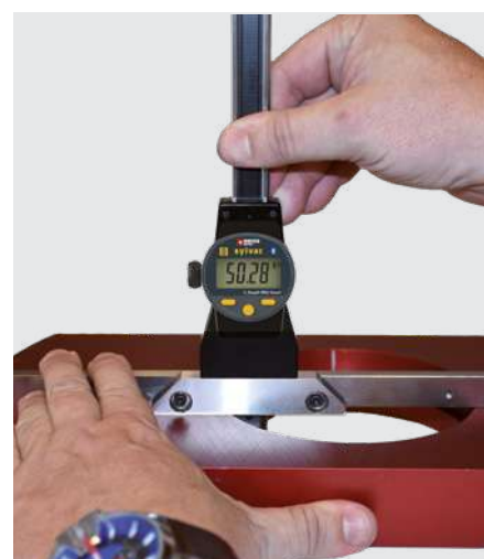
Medición de profundidad en agujero utilizando base adicional
