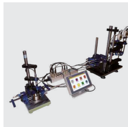
Conexión de palpador e indicadores por entrada M-Bus
