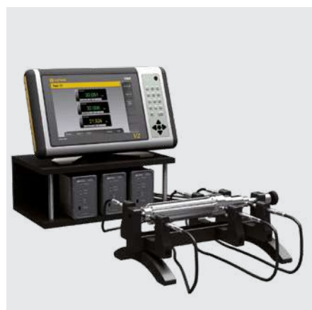
Conexión de palpadores a a D300S por unidad D302
