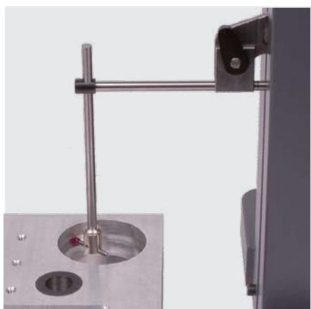
Medición de ranura interna con accesorios 930-2108, 930-2110 y 905-2207
