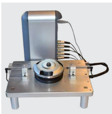
Palpadores capacitivos conectados a un D200S
