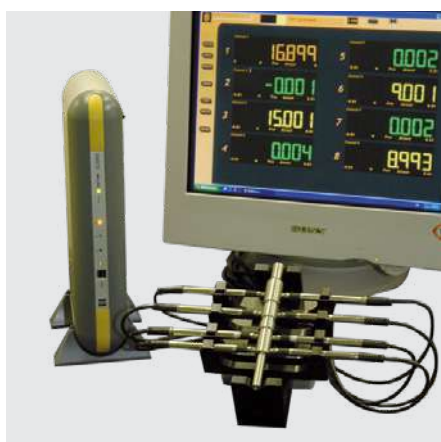
Medición dinámica de varios diámetros (OD /ID)
