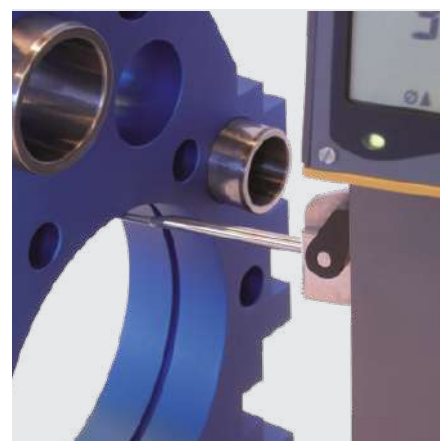
Medición interna con bola de rubí Ø 3 mm, 930-2101 (standard)
