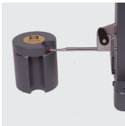
Tomando la constante del palpador con el bloque patrón 930-2002 (standard)
