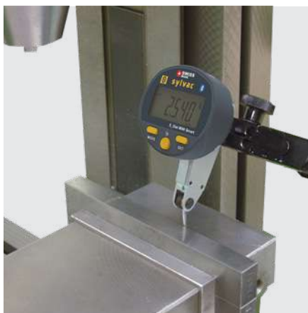
Verificación de planitud en una fresadora
