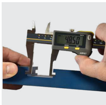
Medición de ranura interior con S_Cal EVO Smart IG
