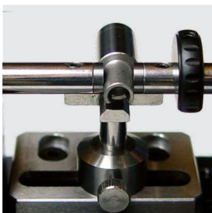
Medición externa con \varnothing 6.5 y mesa XYZ
