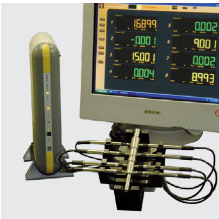
Medición dinámica de varios diámetros (OD /ID)
