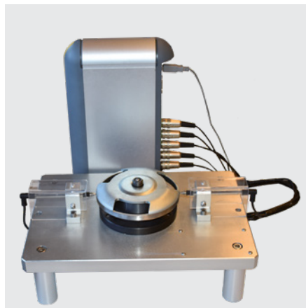
Palpador capacitivo conectado a D200S.
