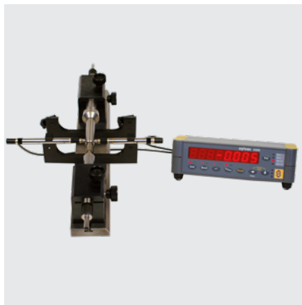
Palpadores P5 conectados a unidad D50S midiendo el diámetro exterior de un eje
