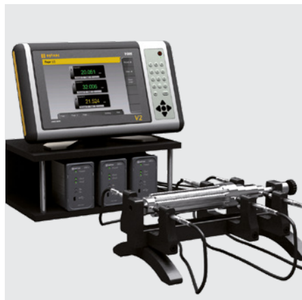
Palpadores P5 conectados a D302 acoplado con un D300S para medición de dia. exterior, concentricidad y cilíndricidad
