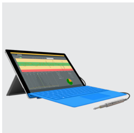
Palpador P12D USB conectado a un PC. Las mediciones muestran en Sylcom.
