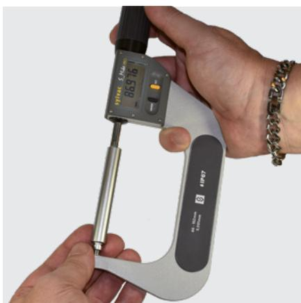
Medición de longitud de pieza torneada
